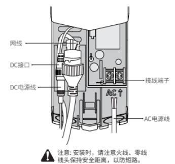
④将电源内盒推入外壳，确认卡扣锁紧，并固定螺钉。
