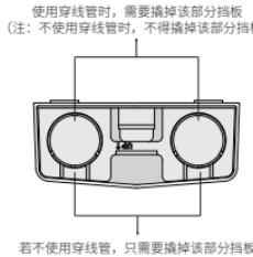
③将监控摄像机的DC电源线与稳压电源DC接口连接，将AC电源线与接线端子相连接，同时可将网线收纳入盒，通过螺丝将壳体固定。
